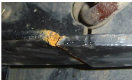
รูปที่ 1 ลักษณะความเสียหายของแชสซีในจุดรอยเชื่อม
